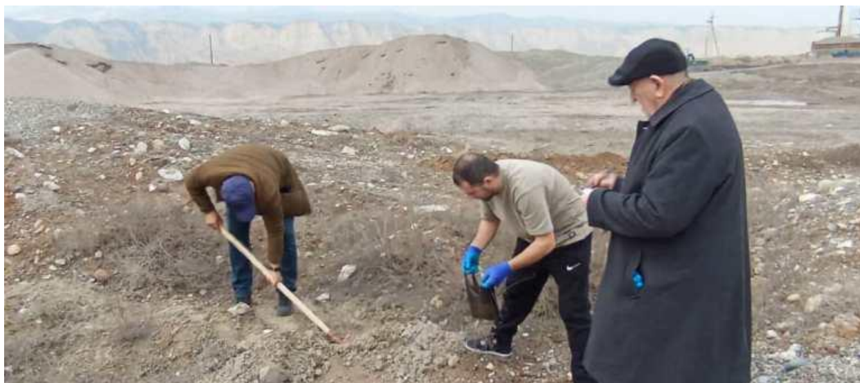
Отбор проб в зоне влияния бетонного завода, 20.02.2025г, 12:00ч
